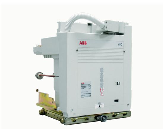
I contattori di media tensione VSC/P sono progettati per funzionare in corrente alternata e sono di norma impiegati per comandare utenze che richiedono un elevato numero di manovre su base oraria. Sono idonei per comandare e proteggere motori, trasformatori e banchi di rifasamento.
