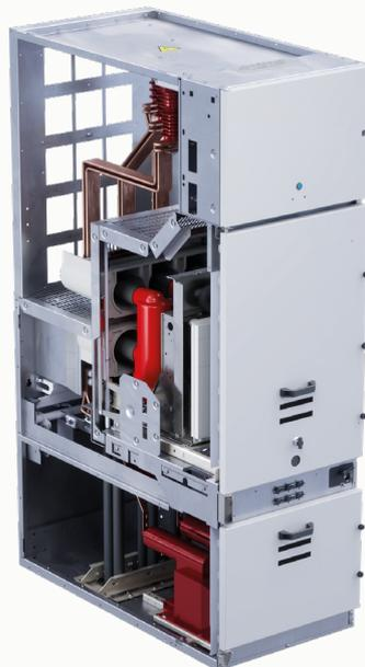
Unità disponibile nella larghezza 600 mm (12-17,5 kV) e 750 mm (24 kV). L'alimentatore WBC con interruttore o contattore estraibile è utilizzato per il controllo e la protezione di impianti in cui la continuità del servizio, gli elevati livelli di sicurezza e le elevate caratteristiche elettriche sono requisiti fondamentali.
