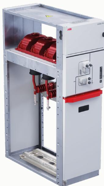
L'unità con interruttore di manovra-sezionatore è impiegata principalmente come un'unità di arrivo, ad anello o di derivazione. L'unità è dotata di un interruttore di manovra-sezionatore a 3 posizioni: "chiuso", "aperto" o "a terra", impedendo quindi manovre errate.
