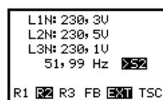
Rilevato errore di sovrافrequenza S2.
