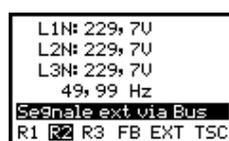
Il dispositivo ha ricevuto un segnale esterno tramite Bus, per selezionare soglie restrittive di sottofrequenza e sovrافrequenza.
