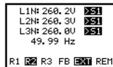
Rilevata sovratensione S1 in tutte e tre le fasi. Se la sovratensione si verifica solo in una fase, >S1 indica la fase con sovratensione.
