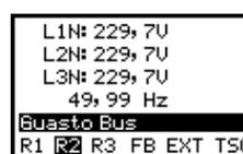
Errore errore bus. Il dispositivo ha rilevato un errore bus, ad esempio, manca un bus master ciclico.
