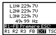
Guasto nel circuito di feedback FB. Ad esempio, guasto del cablaggio, errore di configurazione, contatto di feedback saldato nel DDI. Controllare la configurazione e l'installazione per eventuali errori. Dopo la rimozione dell'errore, premere ESC per riavviare/reimpostare.
