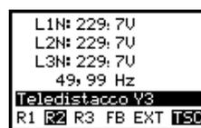
Teledistacco tramite Y3. Indica che il teledistacco è attivato tramite l'ingresso di controllo Y3 e il relè di uscita R1 è diseccitato.
