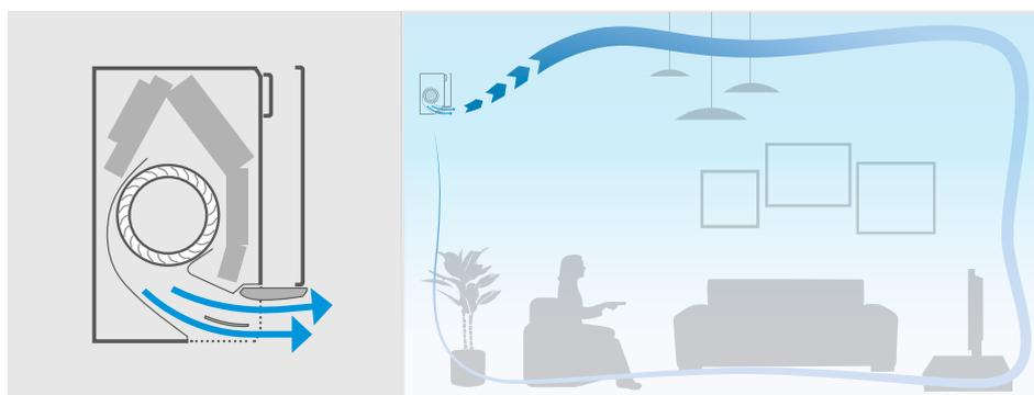
Terminali idronici per installazioni assieme a pompe di calore inverter possono climatizzare l'ambiente tutto l'anno con comandi locali, o via app per poter essere gestiti anche a distanza. Tali sistemi vengono scelti nei locali dove la richiesta di comfort è costante e necessità di flussi d'aria relativamente bassi.
