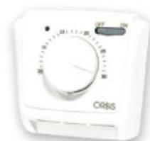
**CLIMA ML e MLI** ambiente, funzionamento a membrana gas, regolazione della temperatura tramite selettore rotativo, limitazione range di regolazione della temperatura, selettore estate/inverno, in aggiunta nel modello MLI è presente un selettore ON/OFF e spia intervento
